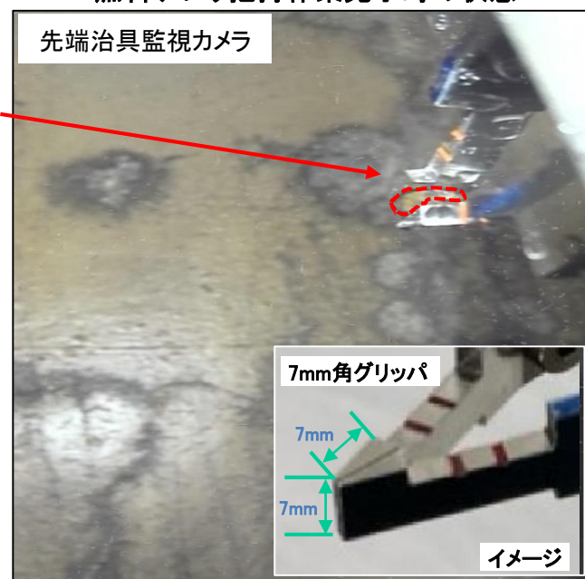
燃料デブリ把持作業完了時の状態
