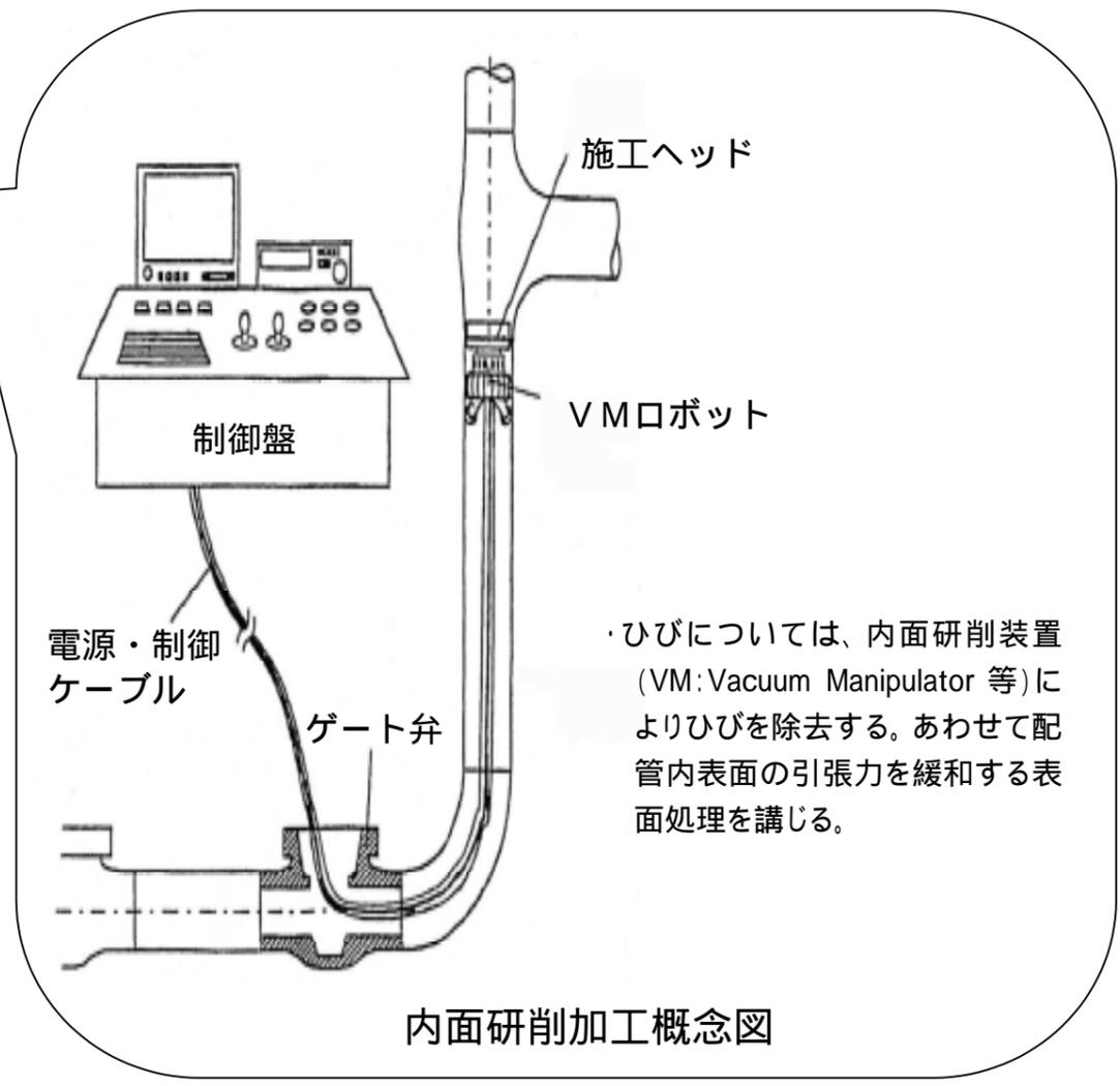
原子炉再循環系配管補修方法概略図
