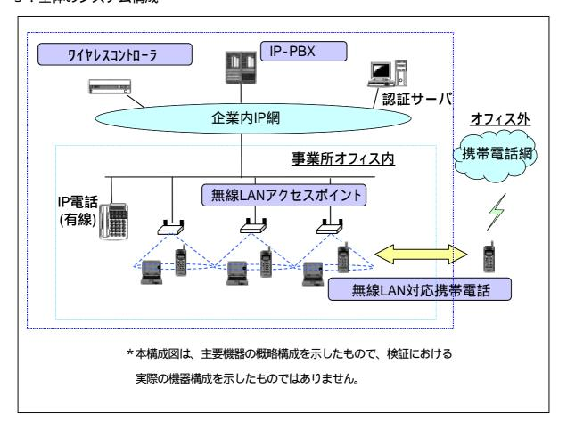
「IP-PBX (Private Branch eXchange)」とは、IPネットワーク上に構築されたIP電話網に、内線電話や外部公衆網への接続・制御を行う構内交換機の機能を提供する装置。
