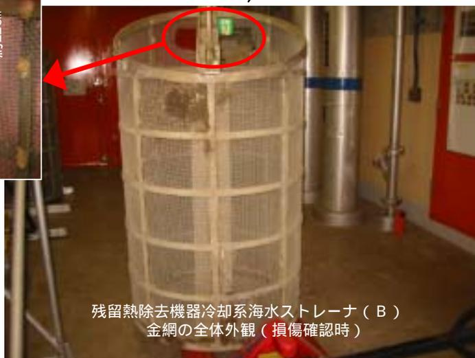
残留熱除去機器冷却系（B系）概略図および金網の損傷状況写真
