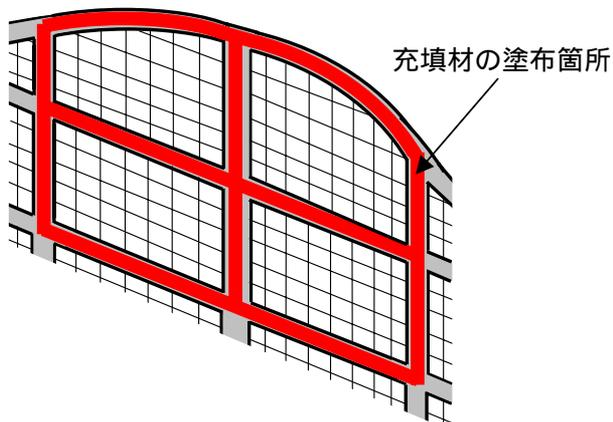
金網および補強材の充填材の塗布箇所
