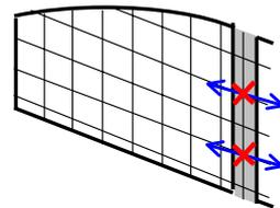
摩耗が進行したことで損傷したものと推定
