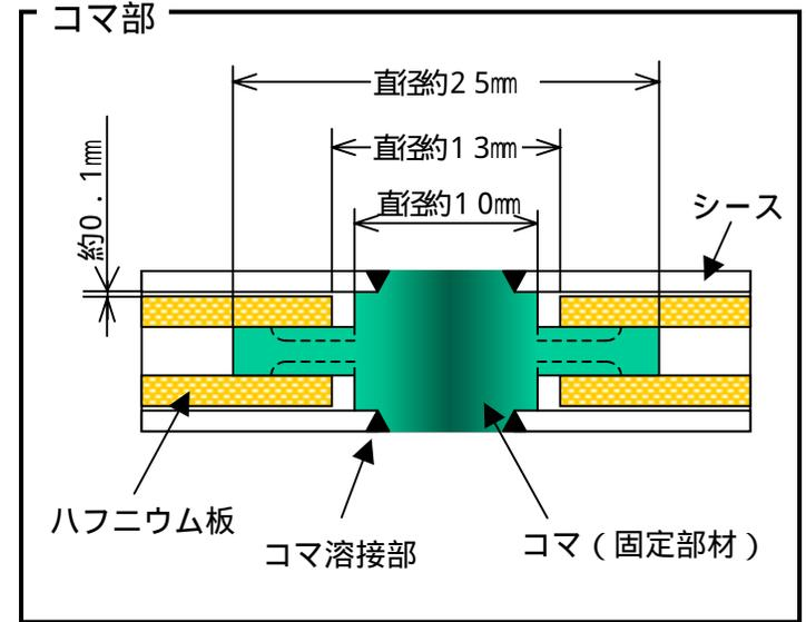
ハフニウム板型制御棒構造図
