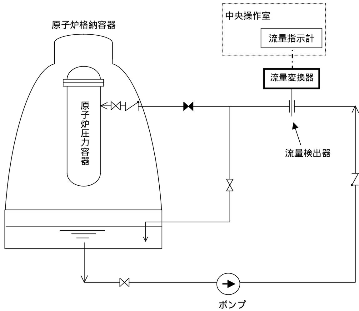
福島第一原子力発電所6号機低圧炉心スプレイ系系統概略図
