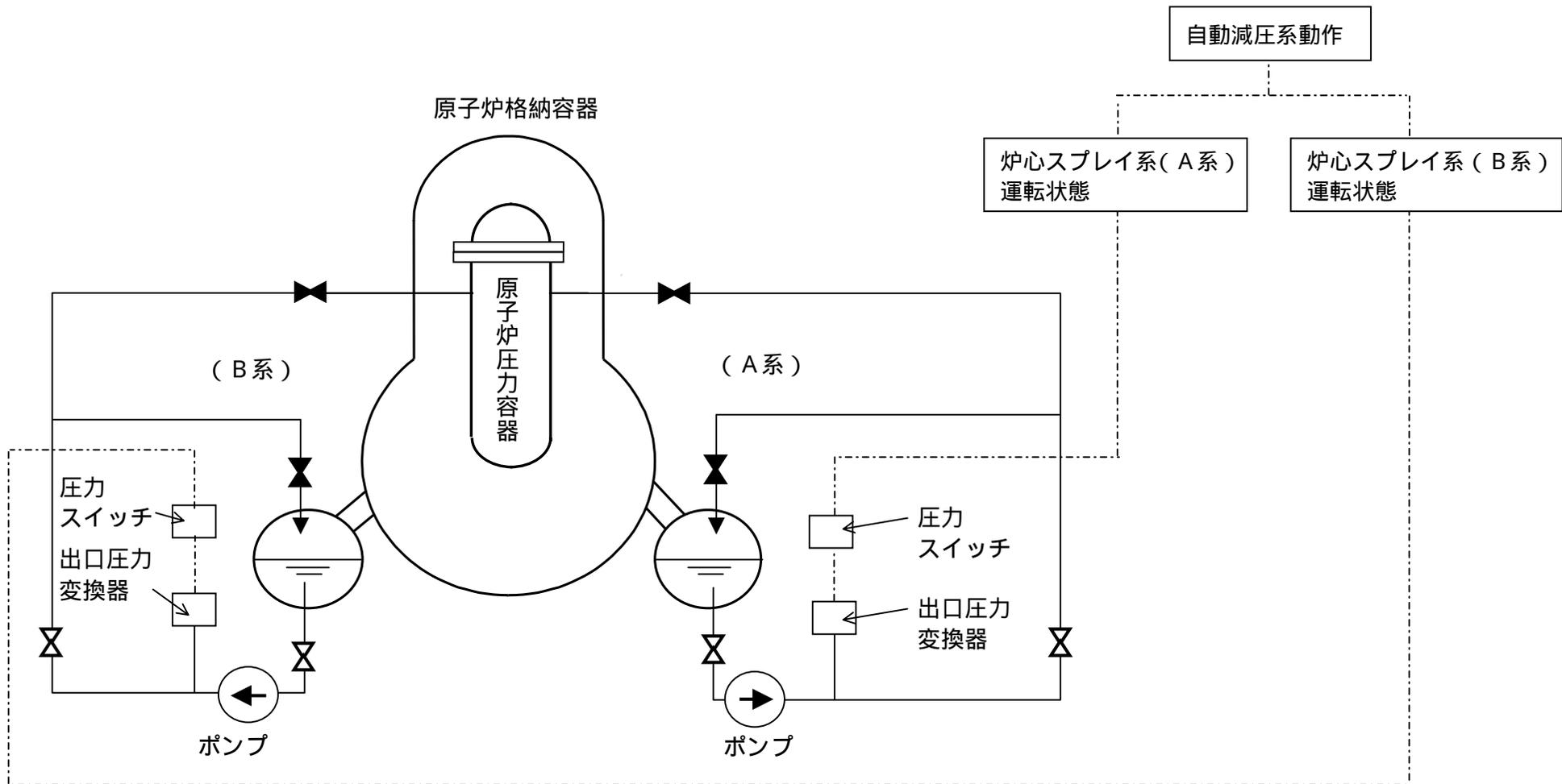
福島第一原子力発電所4号機炉心スプレイ系および自動減圧系の概要図
