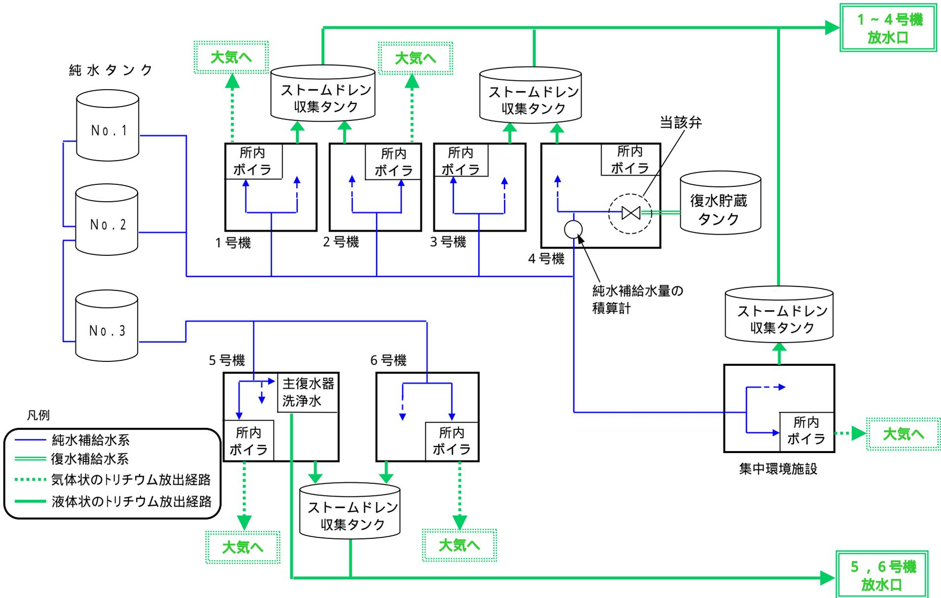
純水補給水系およびトリチウムの放出経路概要図
