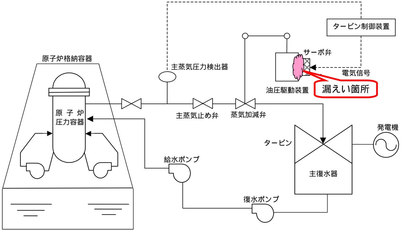
柏崎刈羽原子力発電所 2号機 油漏れ箇所概略図
