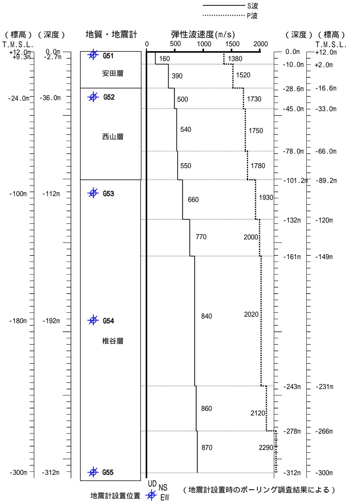
図3 5号機地盤系の概要
