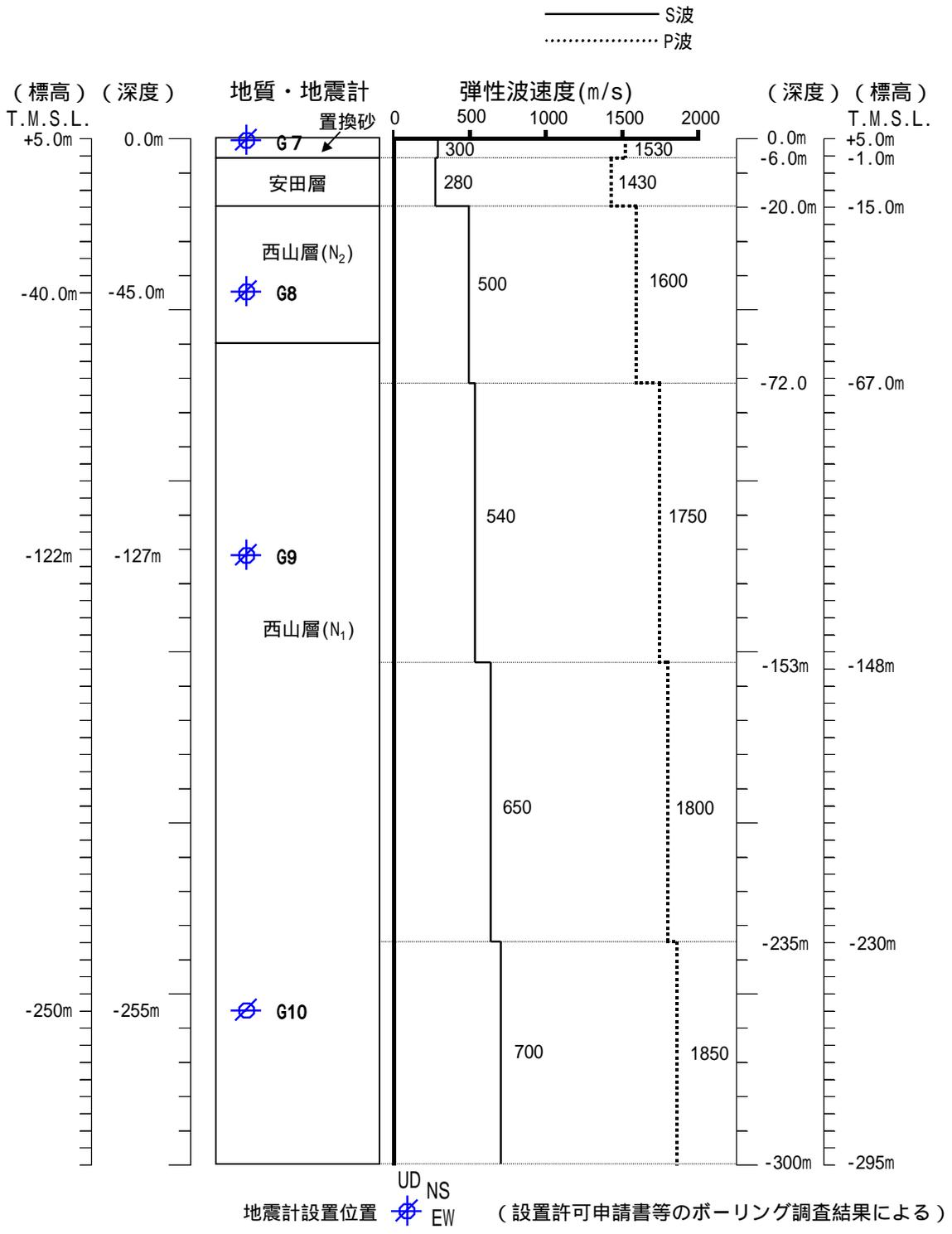
図2 1号機地盤系の概要
