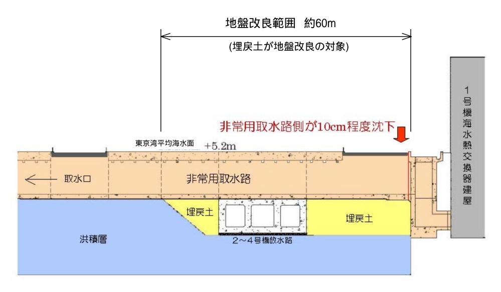
地震により非常用取水路側が10cm程度沈下したため、埋戻土について地盤改良を行う。 現在、地盤改良のための準備作業を実施中。平成21年1月より工事開始予定。
