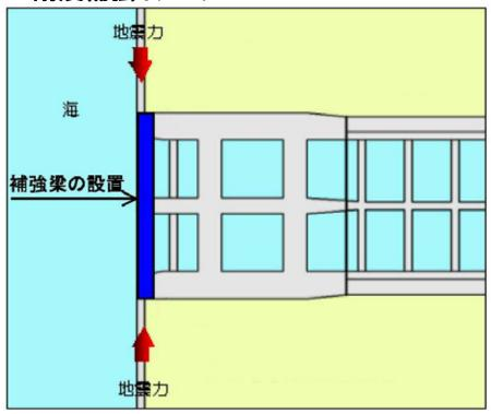
地震の影響を受けた非常用取水路取水口に補強梁を設置し補強する。
