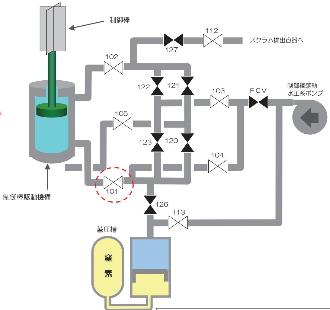
警報発生（3/26 14時23）時の弁の開閉状態を明示
