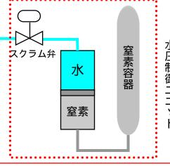
原子炉緊急停止(スクラム)信号が発信されると、水圧制御ユニットに取り付けられたバルブ(スクラム弁)が開き、水圧制御ユニット内に充てんされていた水圧を制御棒駆動機構の駆動ピストンに与え、制御棒を原子炉内へ挿入する。
