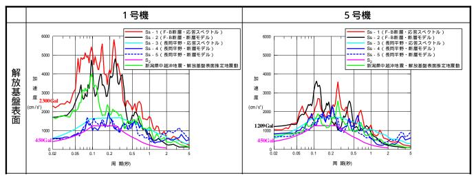
耐震設計審査指針(昭和53年9月初制定,昭和56年7月改訂)に対するバックチェック時の基準地震動S。
