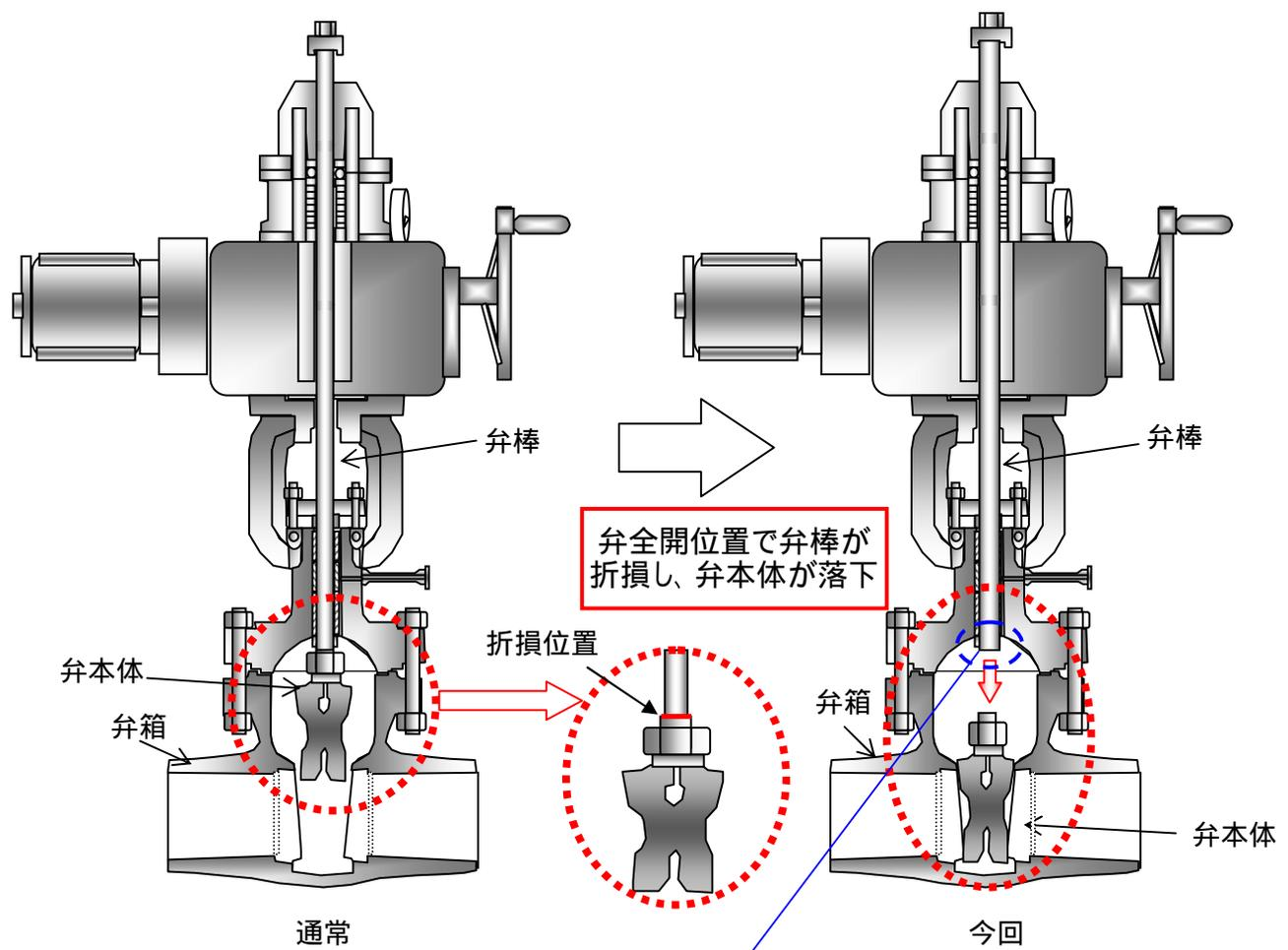
原子炉隔離時冷却系蒸気管内側隔離弁断面図
