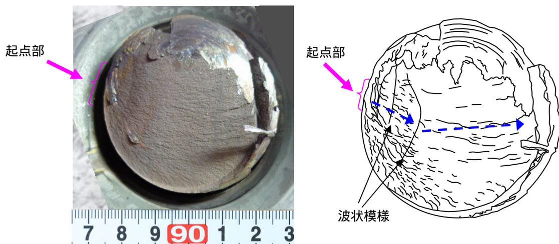
折損した弁棒の破面状況
