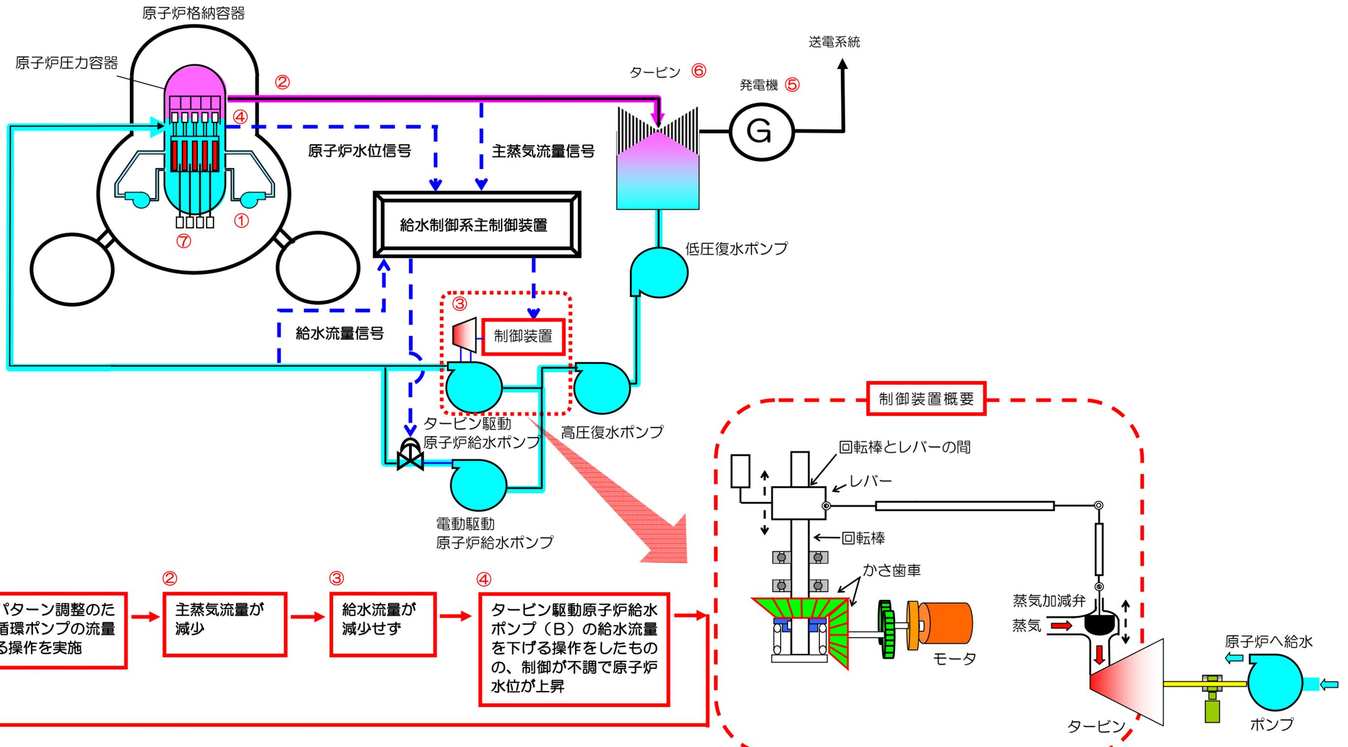
① 制御棒パターン調整のため、再循環ポンプの流量を下げる操作を実施
