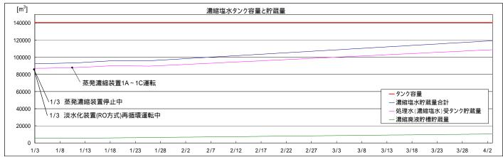
記 ・処理装置の処理量は、1,020m³/dと想定(T/B滞留水水位等の状況により処理量を変更)
