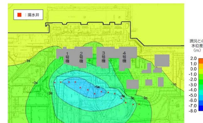
図7 地下水位低下量（想定）
