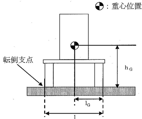
(機器重心までの高さおよび評価点から機器重心までの距離は、4号機二次系ポンプと同様の値となる。)
