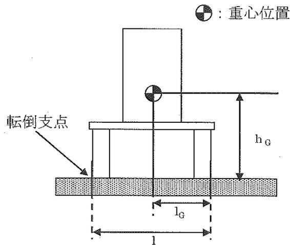
(機器重心までの高さおよび評価点から機器重心までの距離は、1号機二次系ポンプと同様の値となる。)
