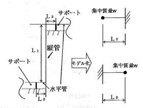
片持ちはりの先端荷重より求まる 自重による応力
