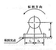
CH: 水平方向設計震度 (0.21) C<sub>p</sub>: ファン振動による震度( ) M<sub>P</sub>:ファン回転により働くモーメント (N・mm) l1: 軸心と基礎ボルト間の距離( 軸心と基礎ボルト間の距離(1≤12) d : 基礎ボルトの呼び径 (mm) n : 基礎ボルトの本数 ( ) nf: 引張力の作用する基礎ボルトの評価本数( h : 据付面から重心までの距離( W: 据付面に作用する重量( Ab: 基礎ボルトの軸断面積 (113mm²)
