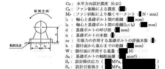
表-1 排気ファンの基礎ボルトの強度評価結果
