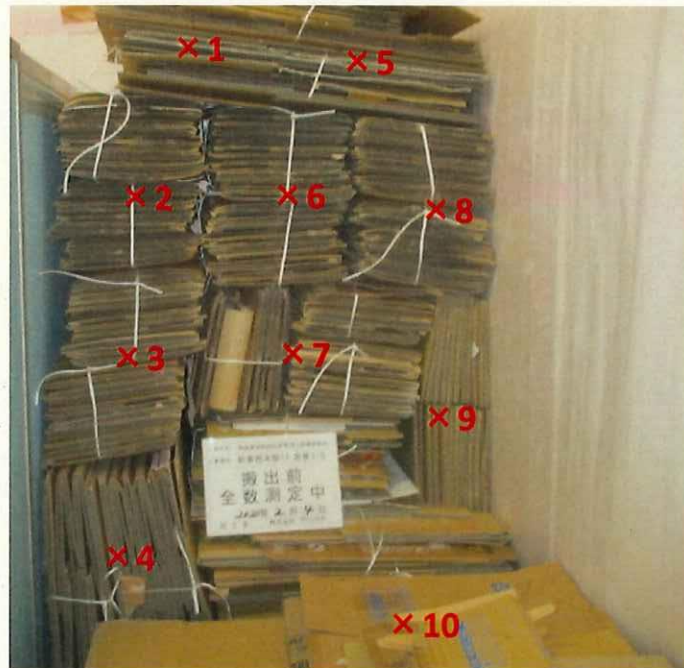
段ボール 表面線量率測定結果 ( \mu\text{Sv/h} )
