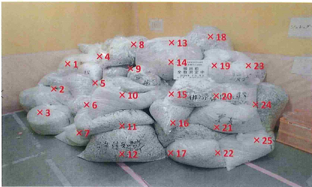
シュレッダー屑 表面線量率測定結果 ( \mu\text{Sv/h} )
