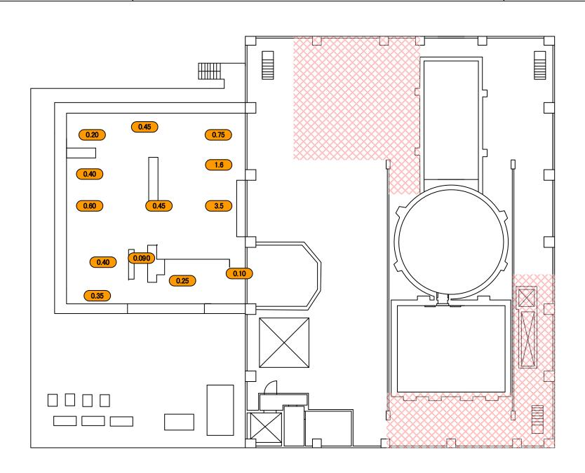
福島第一 原子力発電所 図面名称: 2号機 タービン建屋 地下1階 〔 単位: mSv/h 〕
