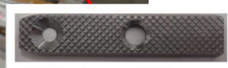
すべり止め対策として製作した爪先部品
