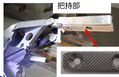
すべり止め対策として製作した爪先部品
