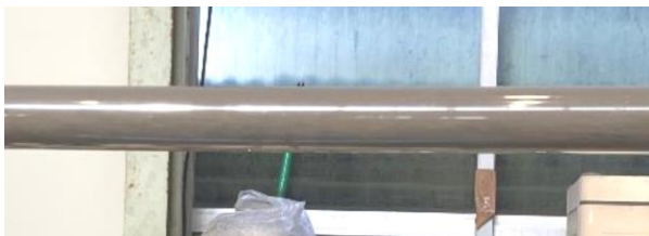
移送試験（平均移送濃度 10 wt%程度）
