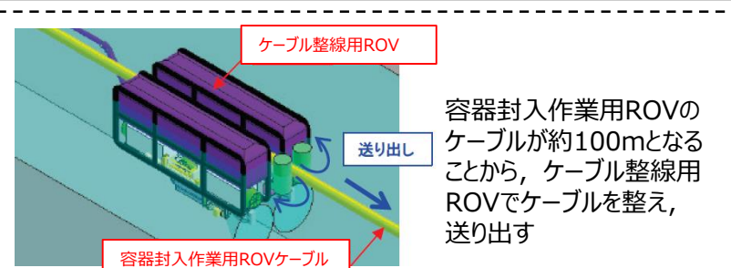
参考) ケーブル整線用ROVイメージ
