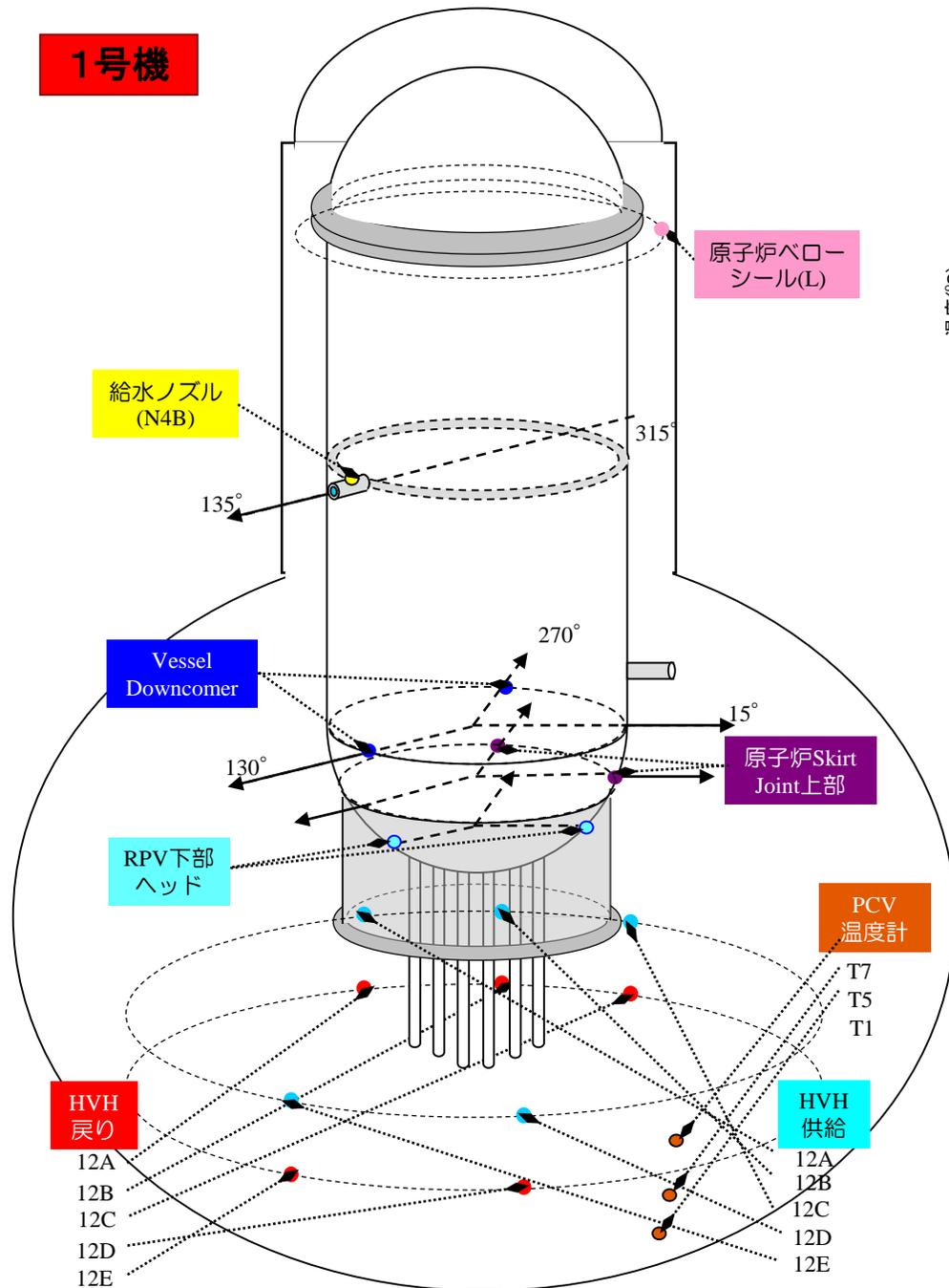
1号機 原子炉圧力容器まわり温度(9/1~3/25)
