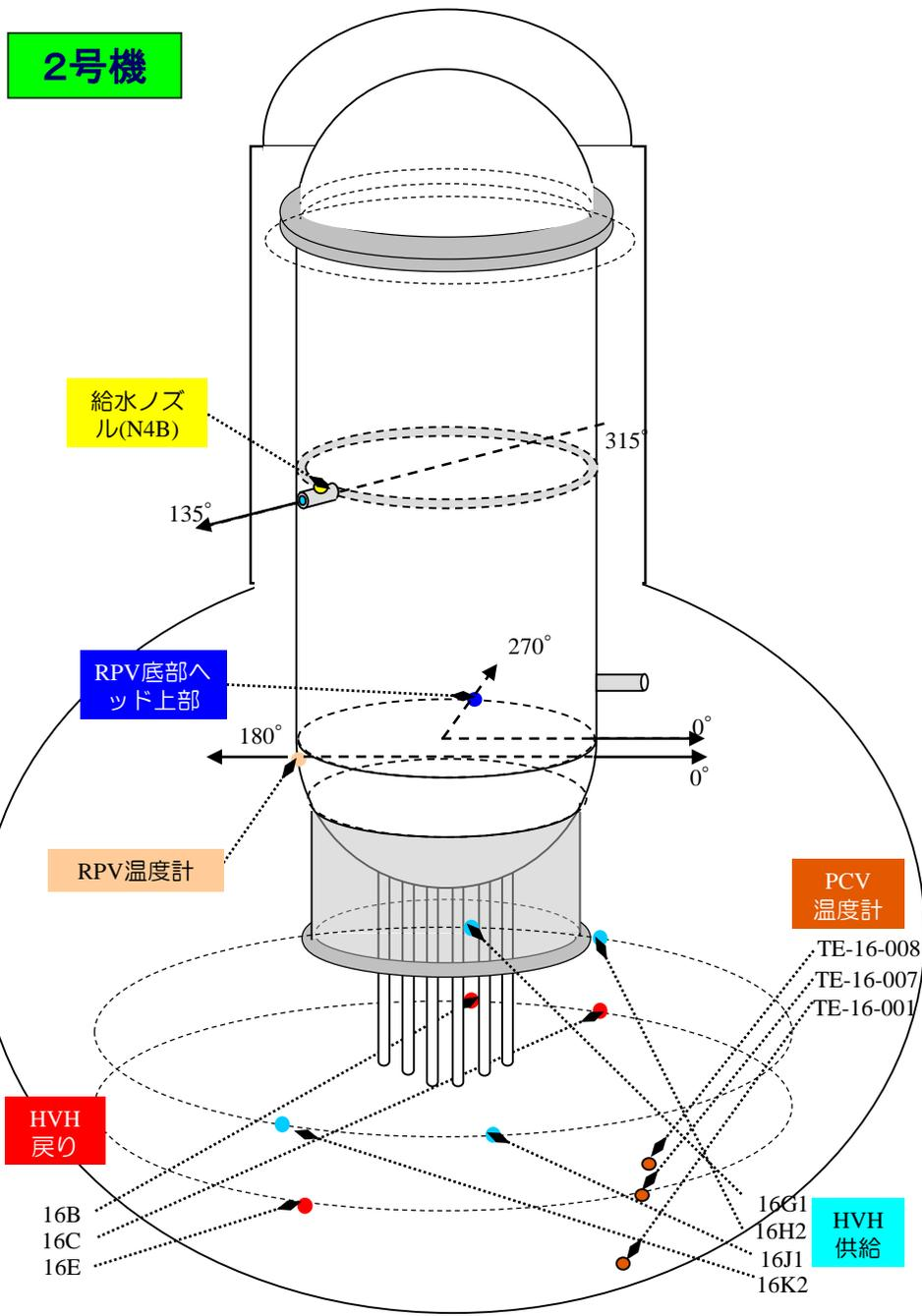
2号機 原子炉圧力容器まわり温度(9/1~3/25)
