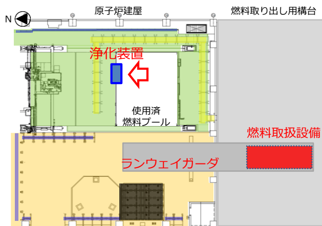
浄化装置設置箇所
