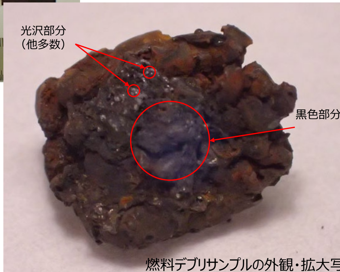
燃料デブリサンプルの外観 (色見本 (カラーセパレーションガイド)、 スケール付)
