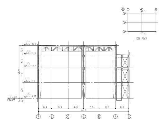
図-7 B-B 断面図 (NS 方向) (単位:m)
