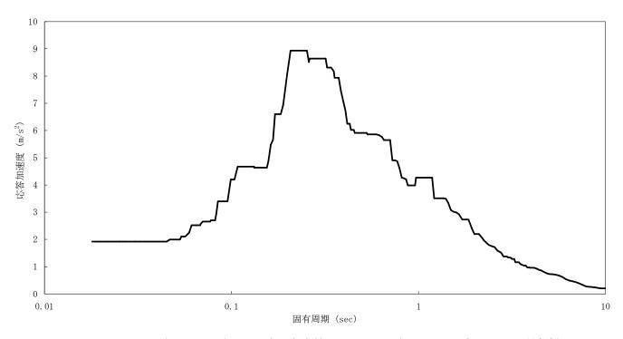
図-7 1FL (G. L. +0. 25) の設計用床応答スペクトル (NS 及び EW 方向, 1.0%減衰)
