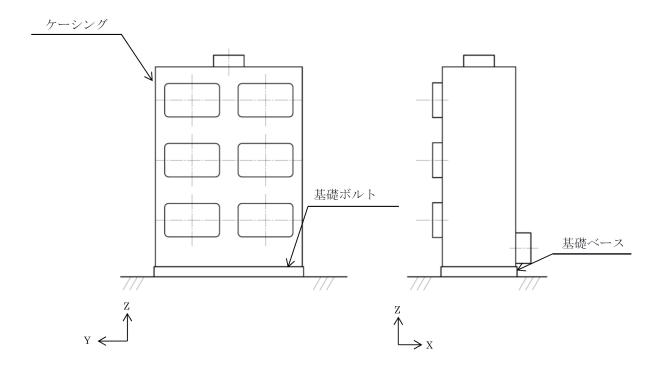
図-13 排ガスフィルタの応力評価箇所
