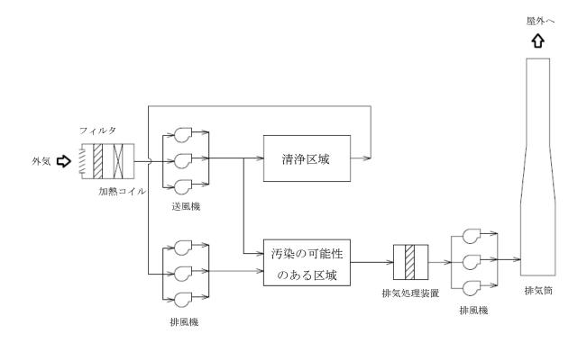
図-1 換気空調設備概略系統図
