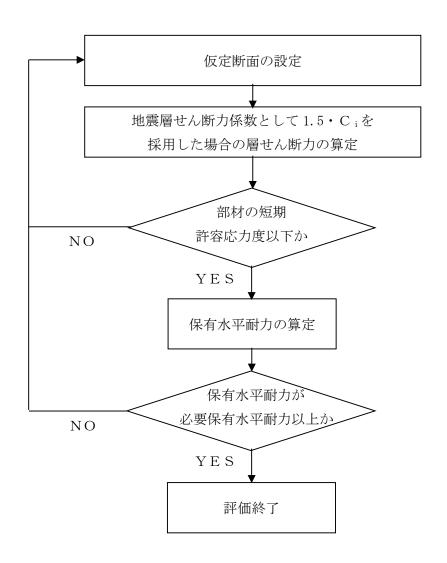
図-8 Bクラス施設としての建屋の耐震安全性評価手順
