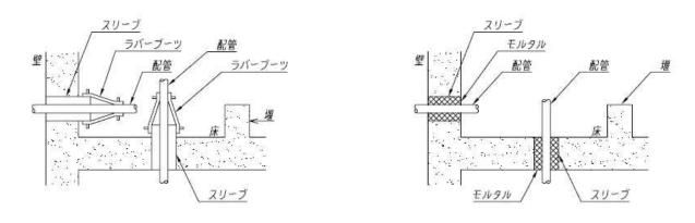
図-5 配管貫通部構造図例(堰の高さ未満の場合)
