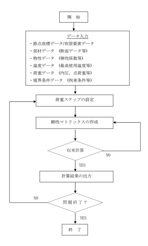
図-1 ABAQUS コードの解析フロー図
