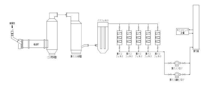
図-1 焼却設備概略系統図
