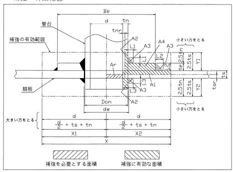
d : 胴の断面に現れる穴の径 (mm)  $t_{nr}$ : 管台の計算上必要な厚さ (mm)
