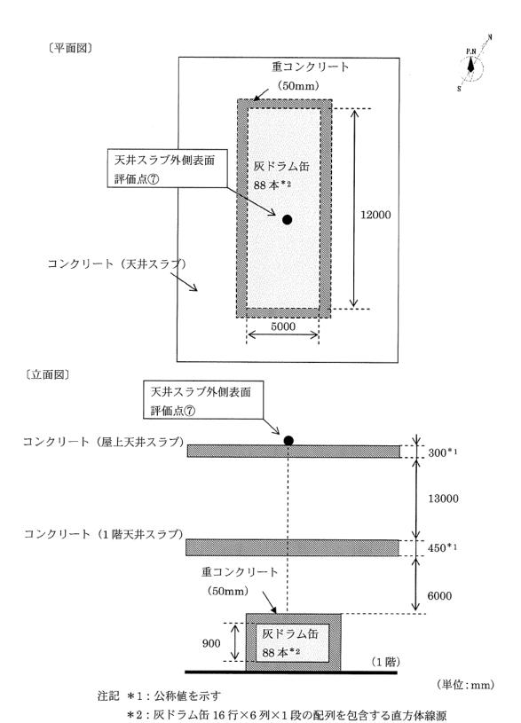
図-11 灰ドラム一時貯蔵庫(南)の天井スラブ外側表面の計算モデル
