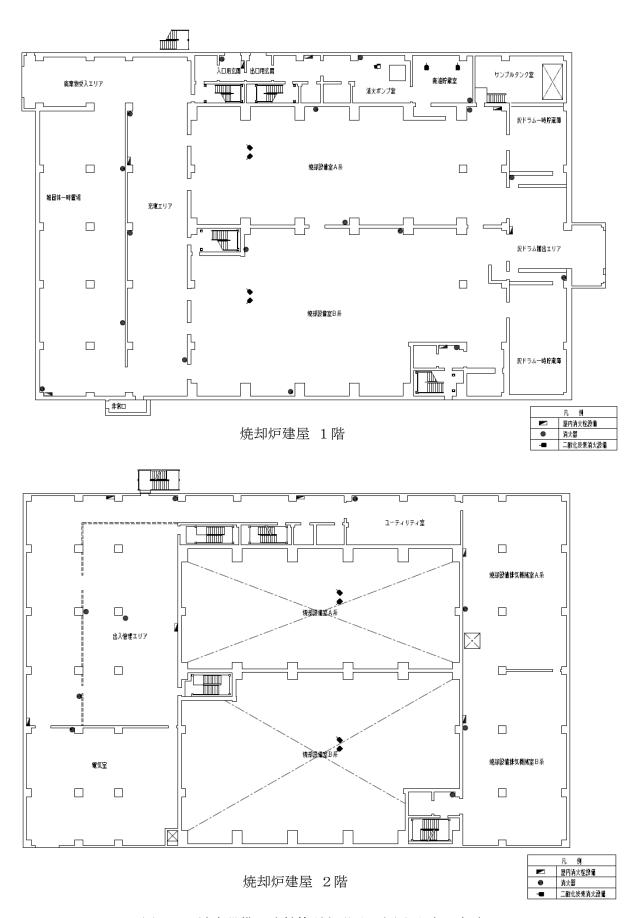
図-1 消火設備の取付箇所を明示した図面 (1/2)
