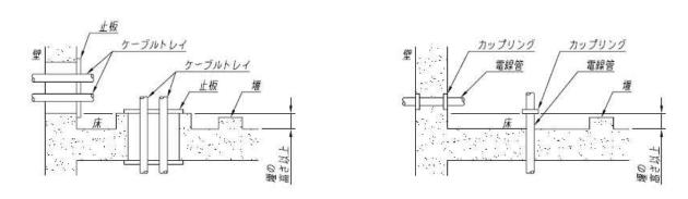
図-6 電気配線貫通部構造図例 (ケーブルトレイ及び電線管)
