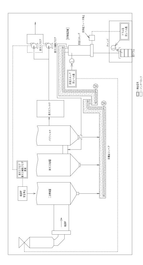
図-1 焼却灰取扱設備の概要
