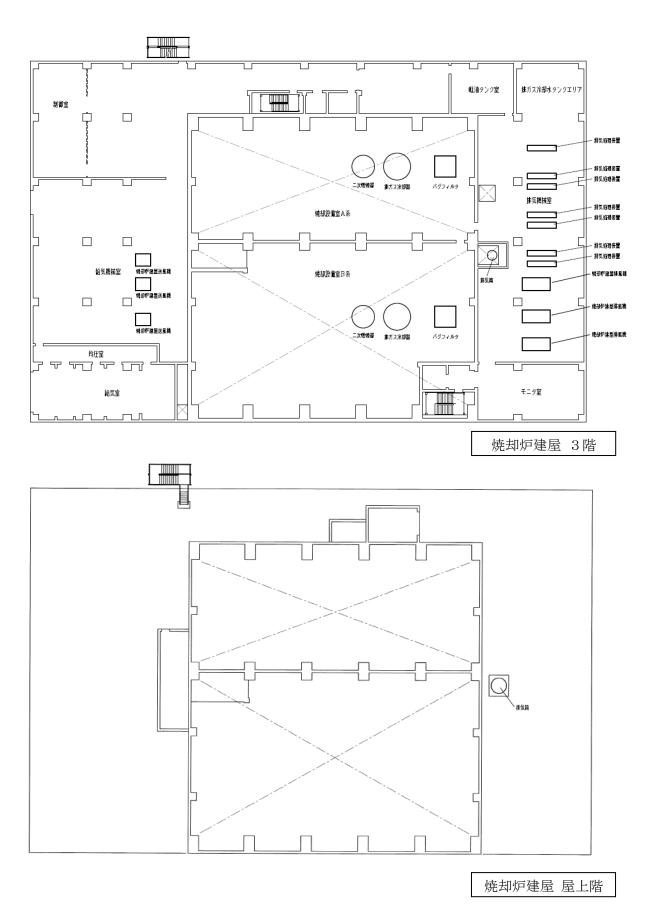
図-1 廃棄設備に係る機器の配置を明示した図面 (2/2)
