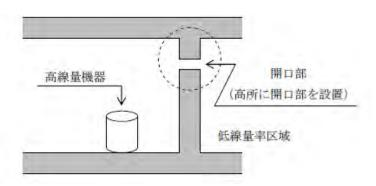
図-12 開口部の高所設置 (例)
