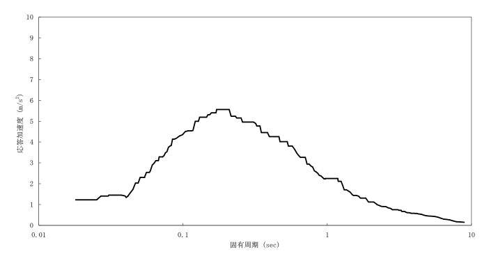
図-4 2FL (G.L.+7.80) の設計用床応答スペクトル (鉛直, 1.0%減衰)
