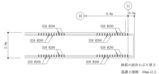
図-10 基礎スラブの配筋図(D通り)
