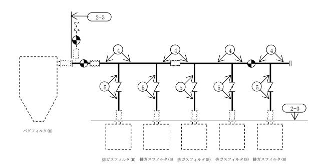
図-15 概略系統図 (バグフィルタ出口から排ガスフィルタ入口までの煙道)
