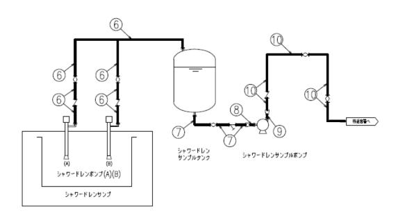
図-5 廃液処理設備 系統図
