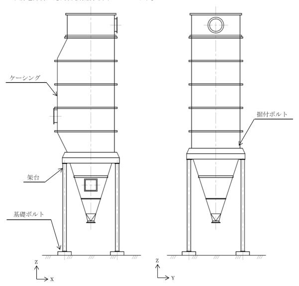
図-12 バグフィルタの応力評価箇所
