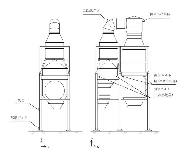
図-11 二次燃焼器/排ガス冷却器の応力評価箇所
