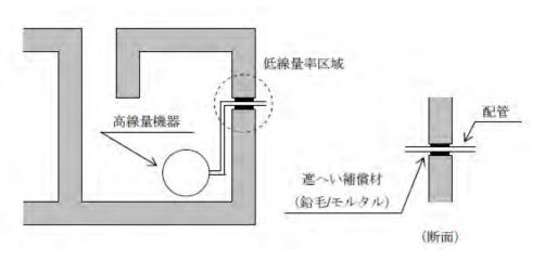
図-13 貫通孔の補償遮へい (例)
