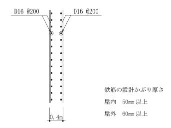
図-9 耐震壁の配筋図
