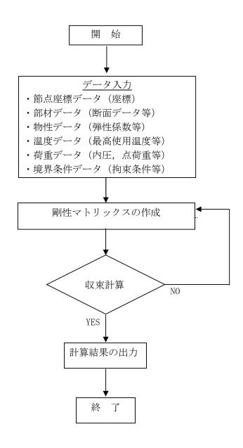
図-1 AutoPIPE コードの解析フロー図
