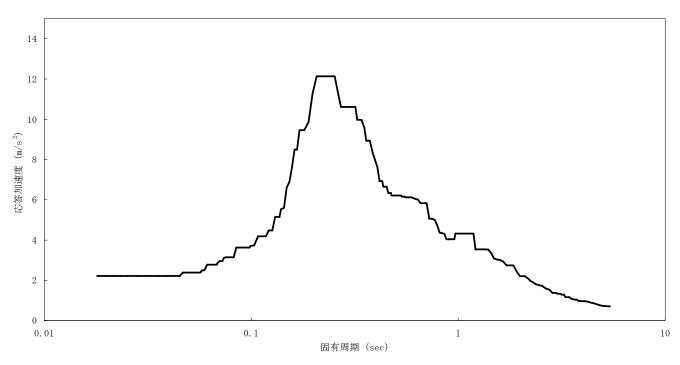
図-5 2FL (G. L. +7.80) の設計用床応答スペクトル (NS 及び EW 方向, 1.0%減衰)
