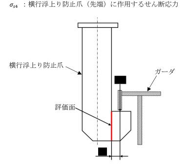
図 6-10 横行浮上り防止爪 (先端)
