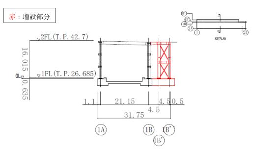
図 1.2-1 (6) B-B 断面図 (EW 方向) (単位:m)
