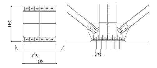
図 1.2-3 柱脚部断面図(単位:mm)
