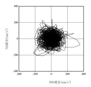
(b) 水平 2 方向の加速度成分のオービット 図 2.1-2 3.11 地震観測記録(自由地盤観測点)
