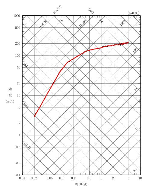
(d) 水平2方向の地震動の応答スペクトル 図 2.1-5 Ss900-1 (2/2)
