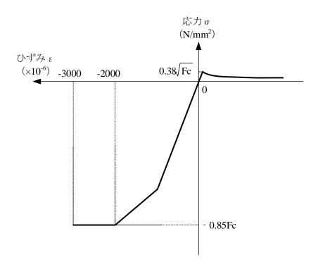
F c:コンクリートの設計基準強度
