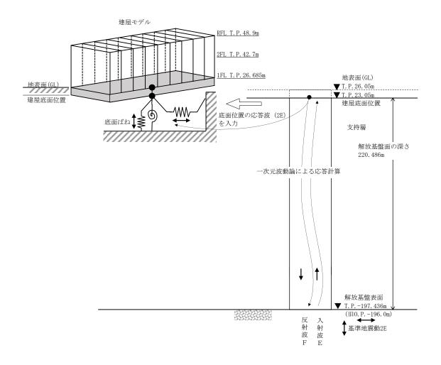
図 3.1-1 地震応答解析に用いる入力地震動の概念図
