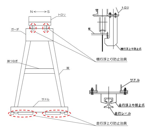
図-2 走行/横行浮上り防止治具外形図
