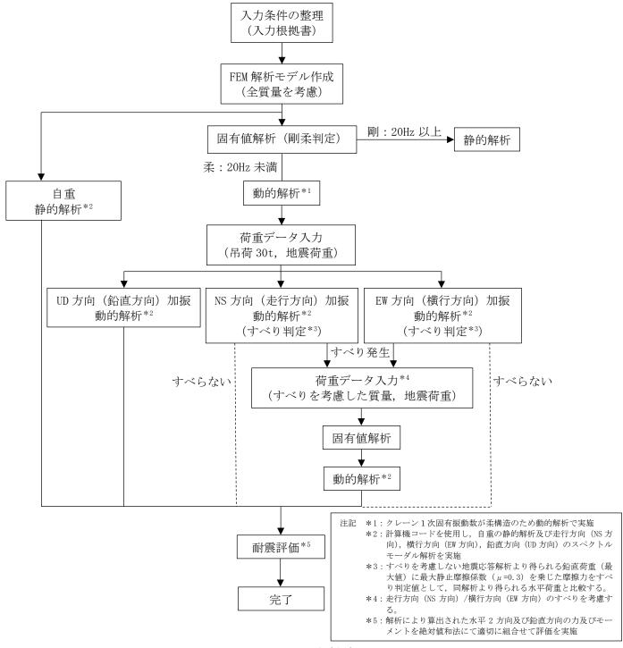
図 2-2 クレーンの耐震評価フロー
