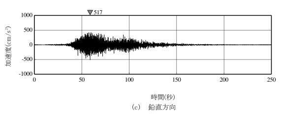
図 3.1-2 (2) 解放基盤表面における地震動の加速度時刻歴波形 (Ss900-2)
