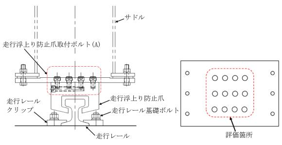
図 6-8 走行浮上り防止爪取付ボルト(A)
