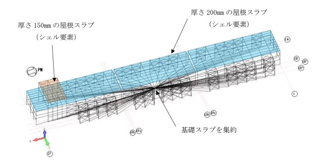
図 3.1-6 建屋の地震応答解析モデル
