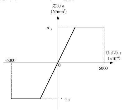
σy:鉄筋の降伏強度
