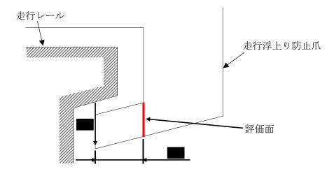
図 6-6 走行浮上り防止爪 (先端)
