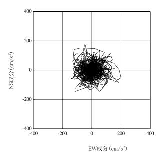
(b) 水平2方向の加速度成分のオービット図 2.1-3 2.13 地震観測記録(自由地盤観測点)
