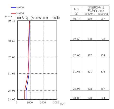
図 3.2-3 最大応答加速度分布(南棟, UD 方向)
