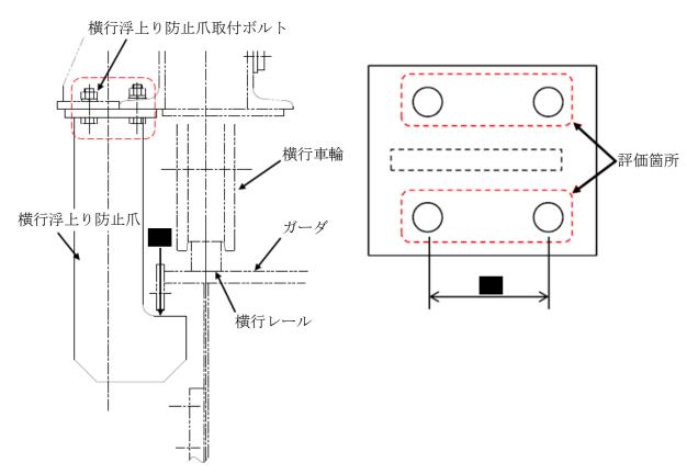
図 6-12 横行浮上り防止爪取付ボルト
