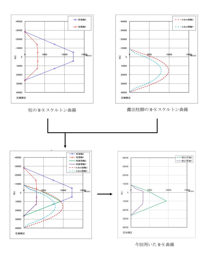
図 3.1-5 (2) 柱脚部の非線形特性
