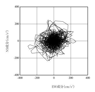
(b) 水平 2 方向の加速度成分のオービット 図 2.1-4 3.16 の福島県沖の地震観測記録(自由地盤観測点)
