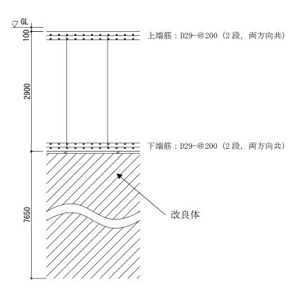
図 1.2-2 基礎配筋図 (一般部) (単位:mm)
