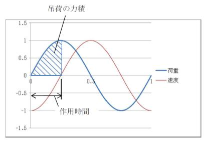
図 6-18 吊荷の力積の概念図
