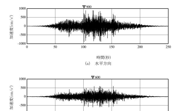
(b) 鉛直方向 図 3.1-2 (1) 解放基盤表面における地震動の加速度時刻歴波形 (Ss900-1)
