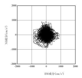
(c)水平2方向の加速度成分のオービット 図 2.1-5 Ss900-1(1/2)
