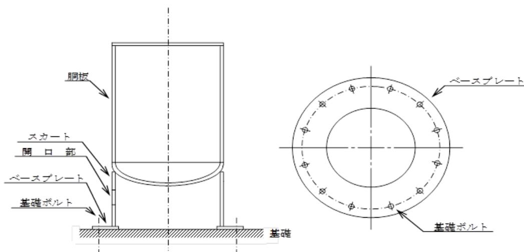
図-1 後段フィルタバッファタンク概要図
