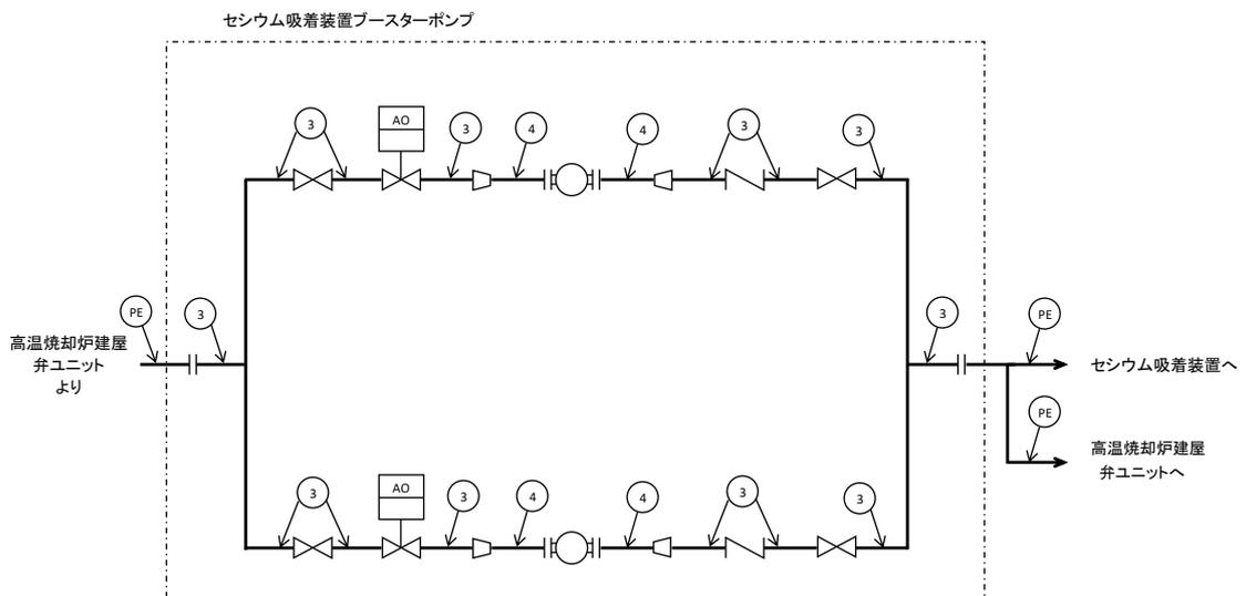
図-1 (4/5) 高温焼却炉建屋 セシウム吸着装置ブースターポンプ周り概略配管図
