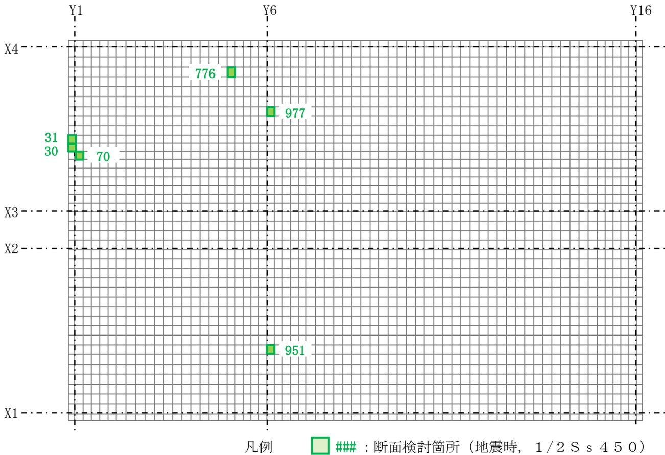
図 3-21 基礎スラブの応力解析モデルと断面検討箇所 (地震時, 1/2 S s 4 5 0)
