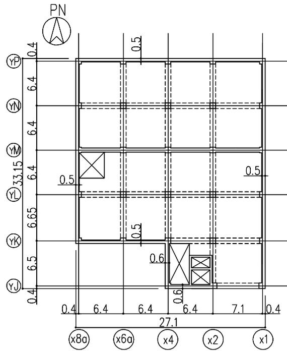
图-19 地下1階平面図 (G.L. -4.2) (单位 : m)
