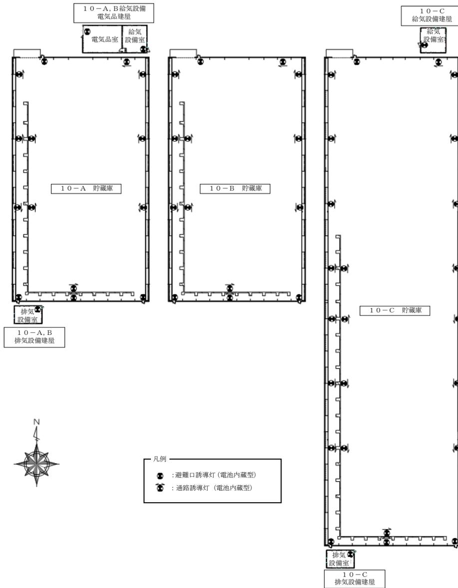
図-4 非常用照明の取付箇所を明示した図面
