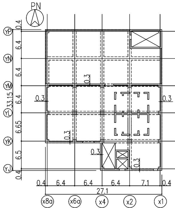
图-22 塔屋階平面図 (G.L.+11.0) (单位:m)
