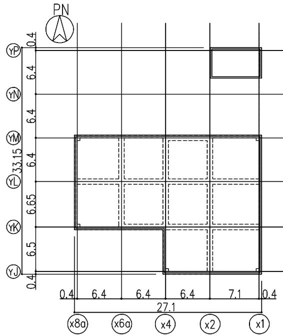
図-23 屋上階平面図 (G. L. +15.4) (単位: m)
