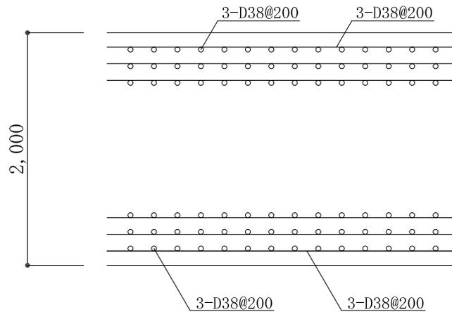
図-10 基礎スラブの配筋図（単位：mm）
