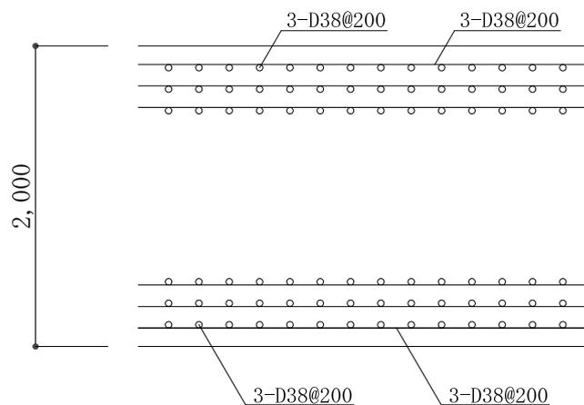
図-5 基礎スラブの配筋図（単位：mm）
