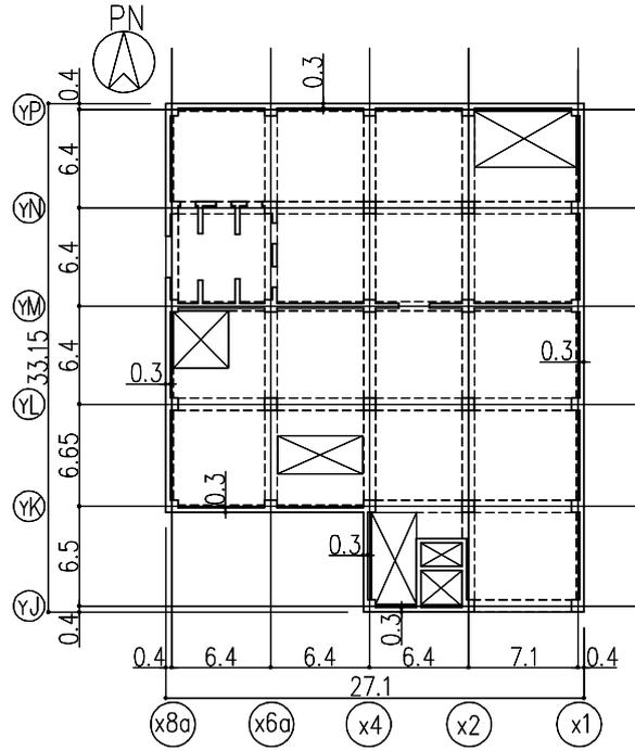
图-21 地上2階平面図 (G.L.+4.7) (单位:m)
