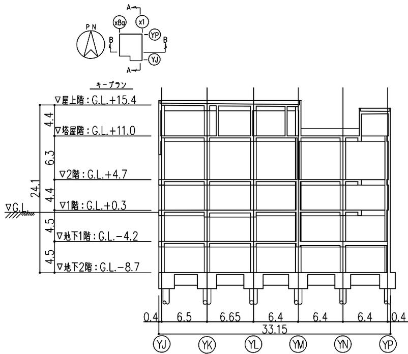
図-24 A-A断面図 (単位: m)
