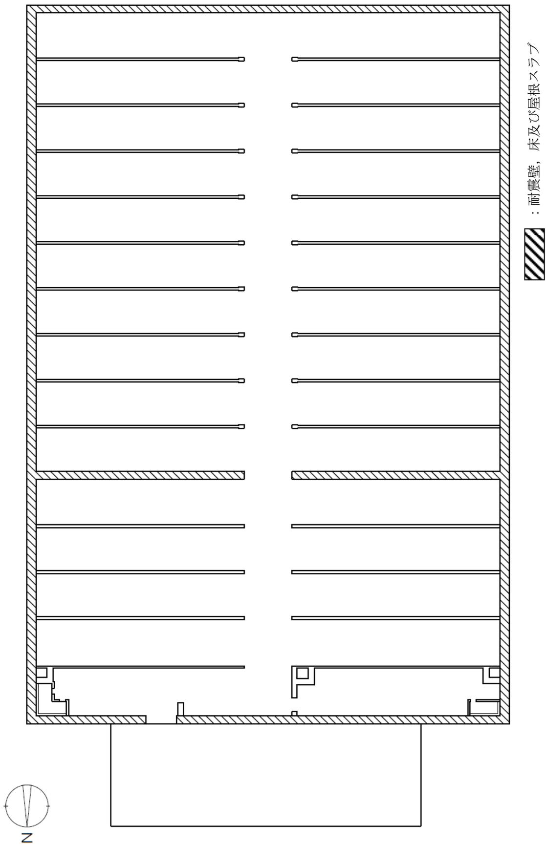
図-5 耐震壁, 床及び屋根スラブを明示した図面 (4/8)
