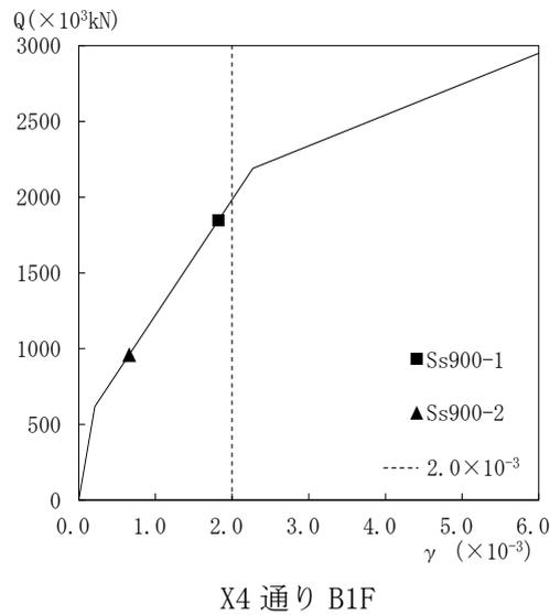
図 2-1 せん断スケルトン曲線上の最大せん断ひずみ
