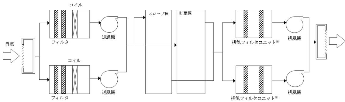
図-12 固体廃棄物貯蔵庫第1棟の換気空調設備概略系統図
