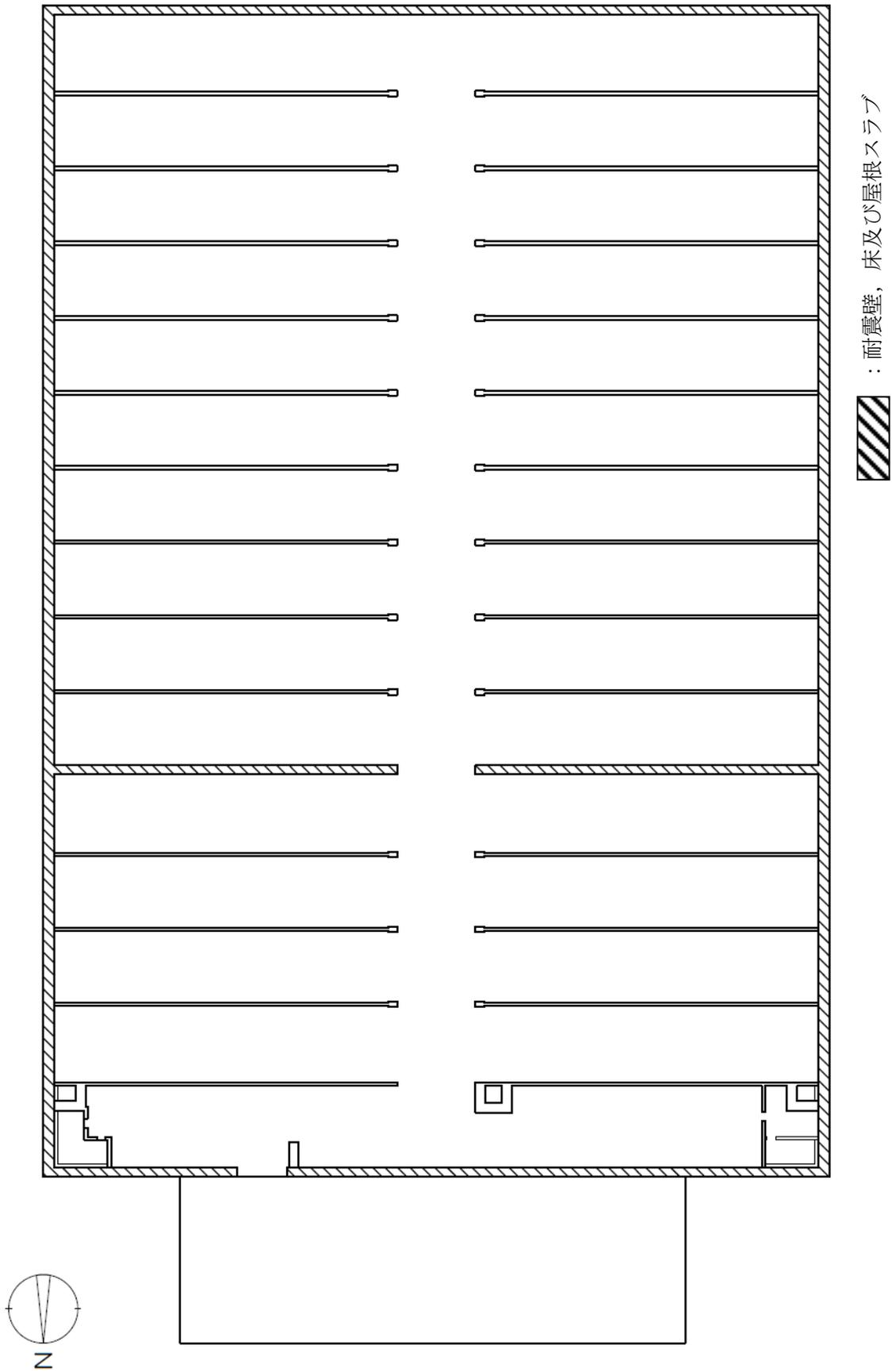
図-5 耐震壁, 床及び屋根スラブを明示した図面 (5/8)
