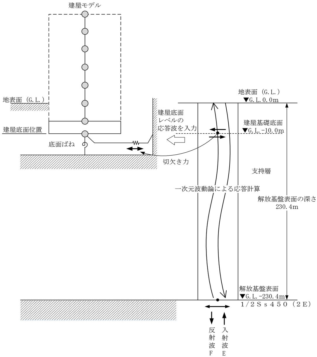
図 3-8 地震応答解析モデルに入力する地震動の概念図 (水平方向)
