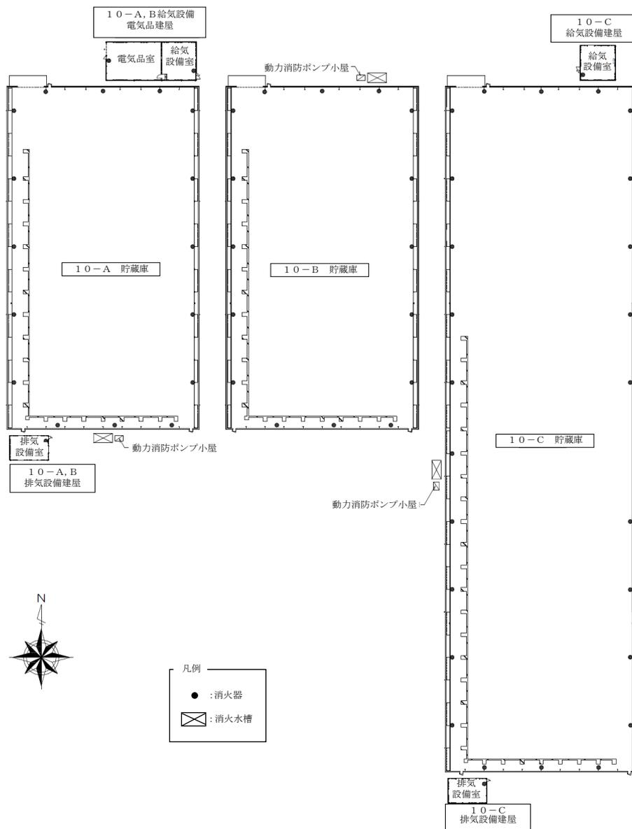
図-2 消火設備の取付箇所を明示した図面
