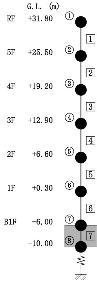
図 3-9 地震応答解析モデル (鉛直方向)
