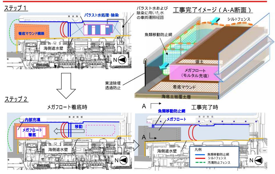
工事期間中は、海底土の舞上りに配慮するため汚濁防止フェンスを設置するとともに、構内排水路からの放射性物質の拡散防止のためシルトフェンスは引き続き設置する。 2
