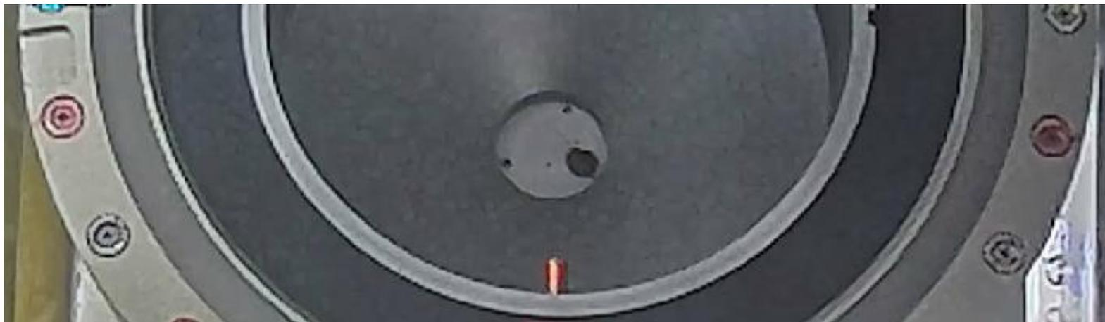
採取した燃料デブリを運搬用ボックス（底部）へ収納した状況
