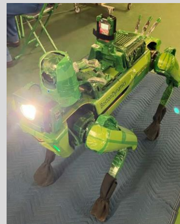
空間線量当量率等の測定に使用した遠隔操作ロボット
