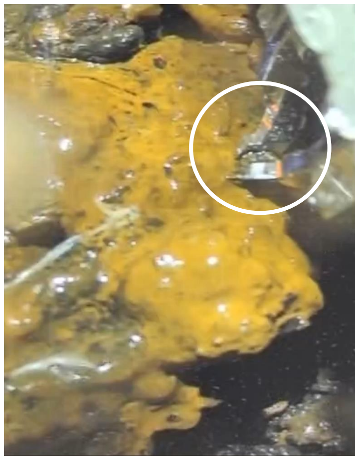
「開口2」底部で燃料デブリを把持した状態
