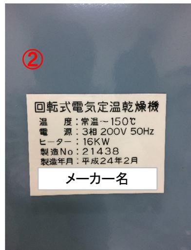
※石炭回転乾燥機・・・石炭に含まれる水分を測定するため、石炭を乾燥する設備
