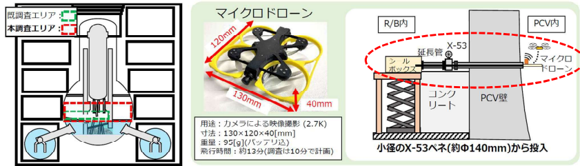
3号機PCV内部調査範囲 縦断面概略図
