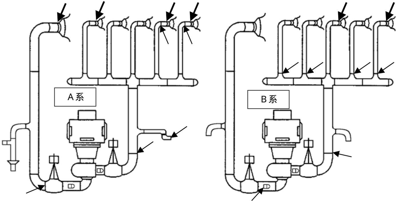
→ : 原子炉再循環系配管の接続部
