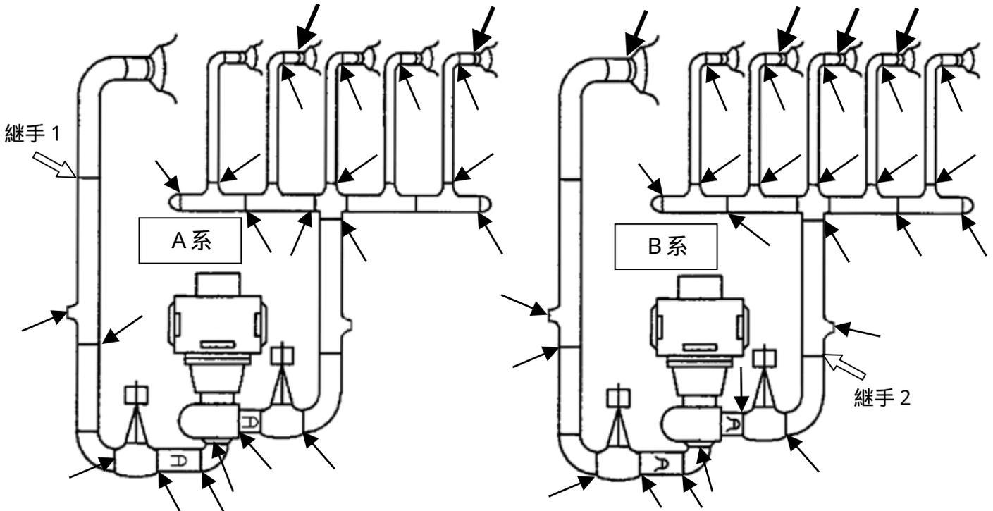
———▶ : 原子炉再循環系配管の接続部 追加点検箇所
