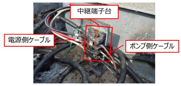
中継端子台およびポンプ側ケーブルに焦げ痕を確認
