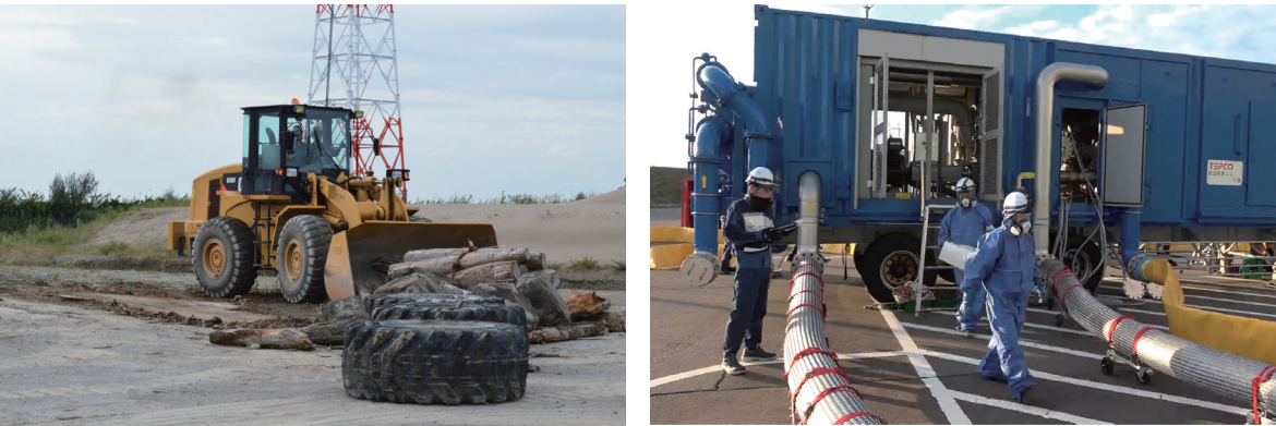
緊急時にも正確かつ速やかに動かせるようにするため、ホイールローダによるガレキ撤去（左）や代替熱交換器車の接続（右）など、可搬型設備の操作・接続訓練を日々行っています。
