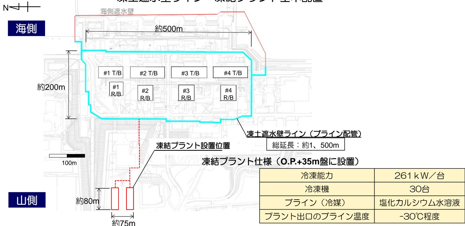
凍結プラントで-30℃程度に冷却したブラインを、ブライン配管を通じて各凍結管に送り、循環させることで凍土を造成する。凍結管内循環後、温度が上がったブラインは再び凍結プラントに送り、冷却する。
