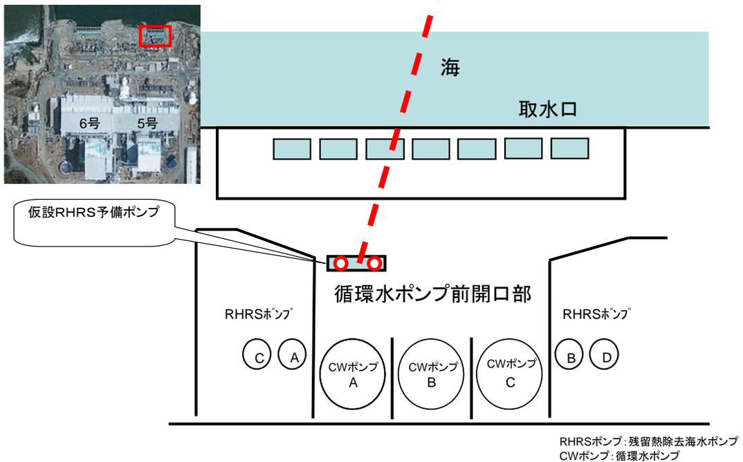
福島第一原子力発電所 5号機仮設RHRSポンプ出口配管部漏えい概要
