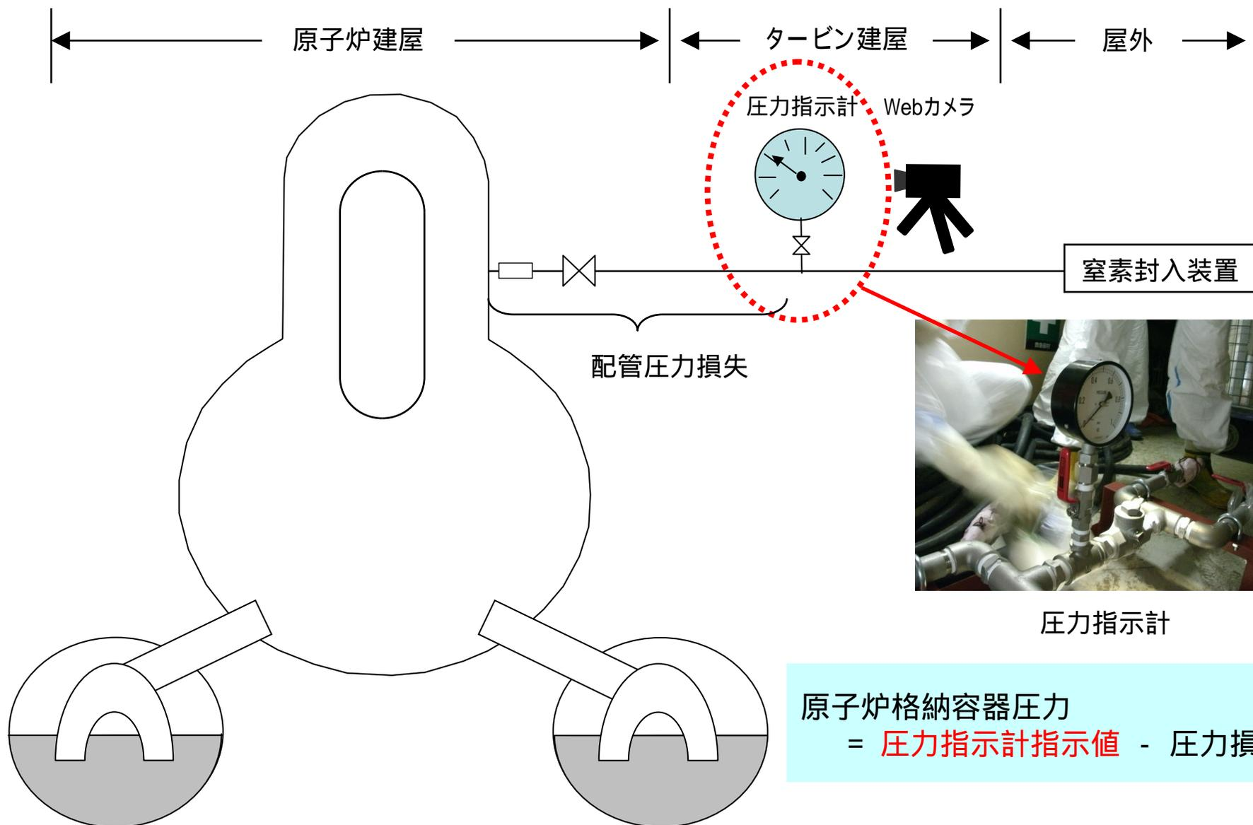
$$\text{原子炉格納容器圧力} = \text{圧力指示計指示値} - \text{圧力損失}$$
