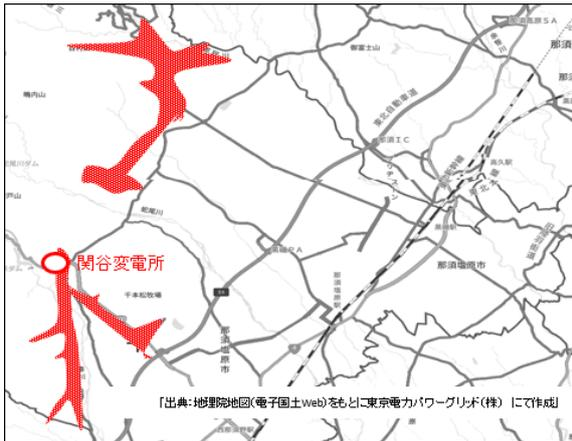
\* 上表のエリアのうち、「一部対象」とされているエリアについては、対象系統（関谷変電所1号変圧器以下の配電線。左図赤線箇所ご参照）でない場合がある。また、対象系統の判断については、接続検討申し込み後に東電PGで確認を行い別途通知する。
