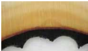
熱履歴による余寿命診断（酸化劣化）
