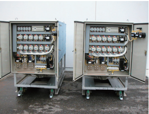
模擬負荷試験装置（開扉）
