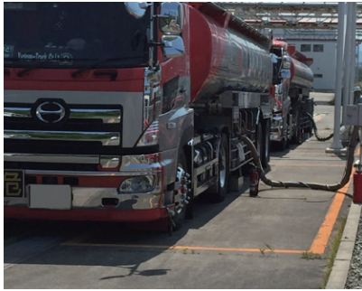
タンクローリーによる注油作業
