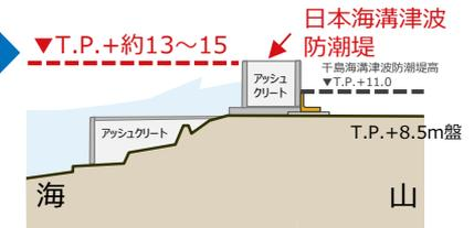
※アッシュクリート：石炭灰（JERA広野火力発電所）とセメントを混合させた人工地盤材料であり、メガフロート工事に於いて活用しています。
